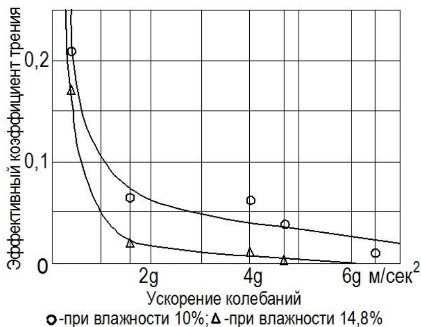
Рисунок 3 – Зависимость эффективного коэффициента трения муки пшеничной по нержавеющей стали от ускорения колебаний
